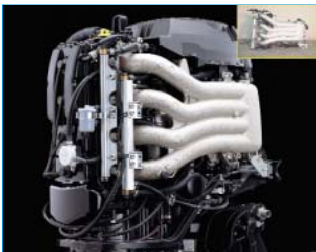
Σχήμα 6.13: Πολλαπλή εισαγωγή μεγάλου μήκους
