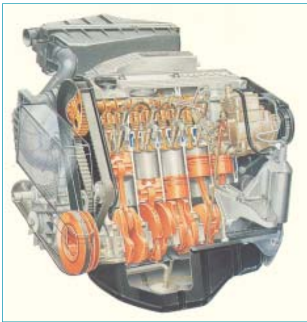
Σχήμα 5.33 Σύγχρονη μηχανή diesel επιβατικού αυτοκινήτου με άμεσο ψεκασμό
