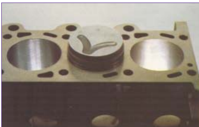
Σχήμα 5.16 Τυπική μορφή κεφαλής εμβόλου
