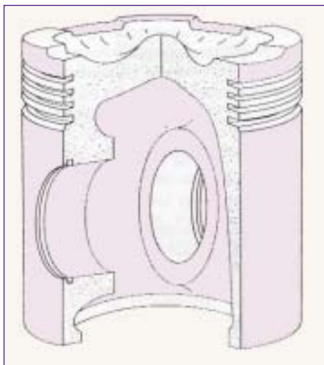
Σχήμα 5.15 Τυπική μορφή εμβόλου (τομή)
