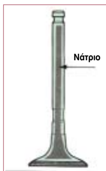
Σχήμα 4.47: Βαλβίδα ψυχόμενη με νάτριο.
