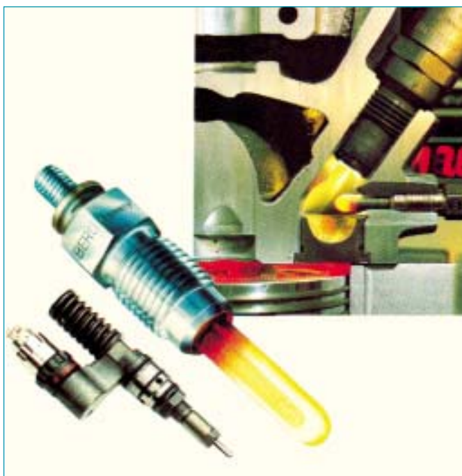
Σχήμα 5.60 Σύστημα υποβοήθησης της εκκίνησης με ηλεκτρική αντίσταση
