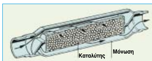
Σχήμα 4.76: Καταλύτης με αντικαθιστώμενα σφαιρίδια.
