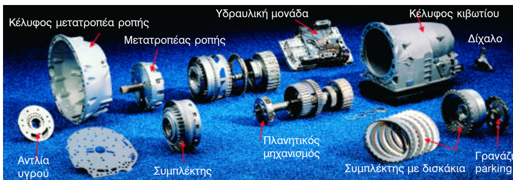
Σχήμα 1.35: Κιβώτιο ταχυτήτων σε τομή με θέσεις εξαρτημάτων.
