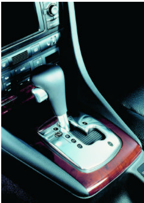
Σχήμα 1.51: Επιλογέας με θέσεις για σειριακή λειτουργία.
