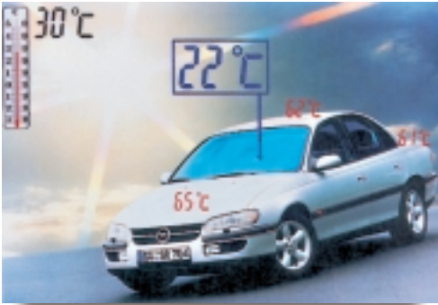
Σχήμα 6.9: Οι θερμοκρασίες γύρω από το αυτοκίνητο. Η αυξημένη θερμοκρασία στην καμπίνα των επιβατών προέρχεται από την ακτινοβολία του ήλιου όταν διαπερνά τα τζάμια ή έχει απορροφηθεί από το μεταλλικό αμάξωμα. Τα φιμέ κρύσταλλα αντανακλούν σημαντικό ποσό ακτινοβολίας, όπως και η ανοιχτόχρωμη βαφή του αμαξώματος.
