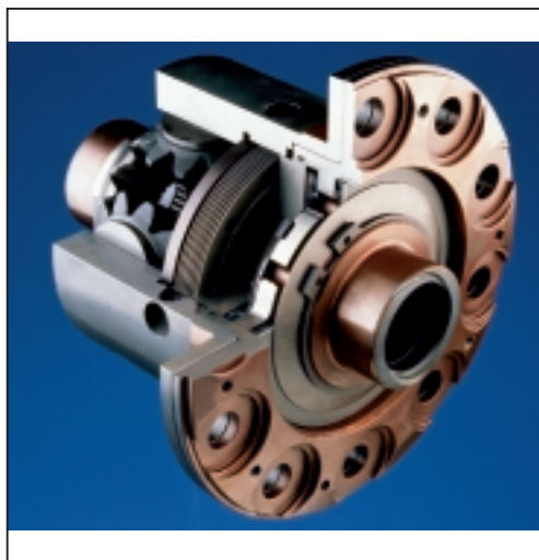
Σχήμα 1.61: Τομή διαφορικού περιορισμένης ολίσθησης (μπλοκέ).
