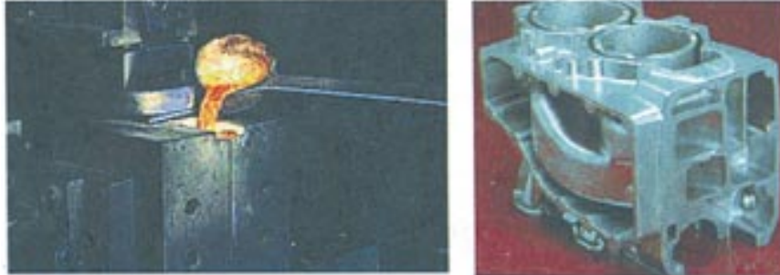
Σχήμα 1.10 Παραγωγή χυτού τεμαχίου
