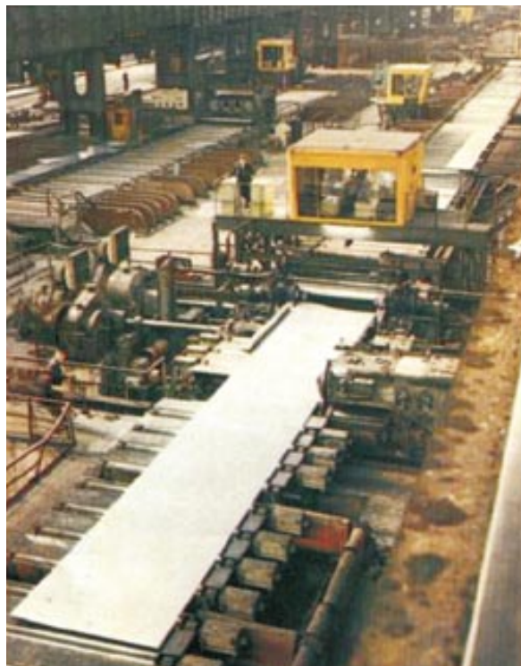
Σχήμα 2.13 Παραγωγή λαμαρίνας με έλαση εν ψυχρώ
