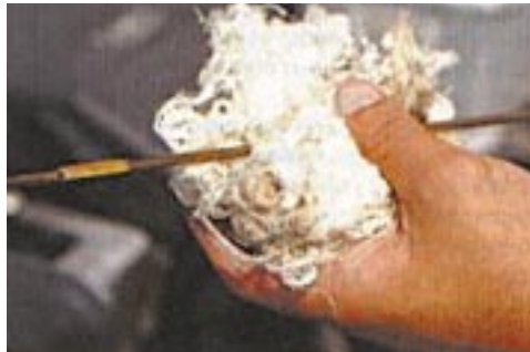
Σχήμα 11.7 Απαιτείται τακτικός έλεγχος της στάθμης του λιπαντικού
