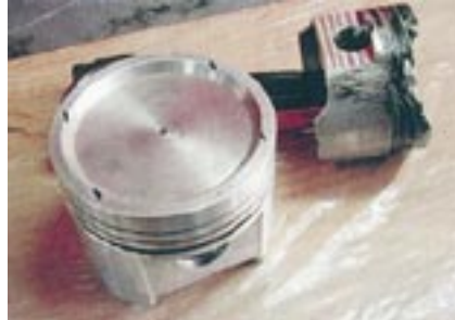
Σχήμα 12.4 Φθαρμένο έμβολο εξαιτίας κρουστικής καύσης σε σύγκριση με καινούριο
