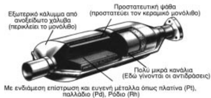
Σχήμα 5.3. Καταλύτης αυτοκινήτου από κεραμικό μονόλιθο
