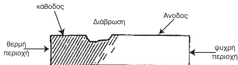
Σχήμα 8.12 Διάβρωση εξαιτίας διαφορετικής θερμοκρασίας στο ίδιο εξάρτημα
