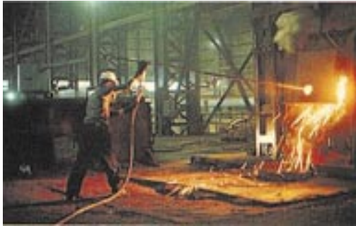
Σχήμα 15.2 Τήξη του μεταλλικού σκραπ σε φούρνο ηλεκτρικού τόξου με εμφύσηση οξυγόνου στη μάζα του λιωμένου μετάλλου
